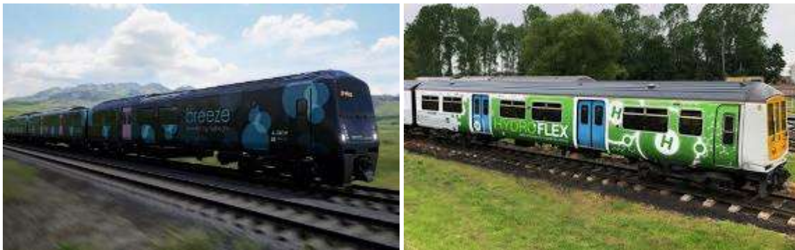
Figures 43 et 44 – Deux types de train fonctionnant à pile à combustible (hydrogène)
