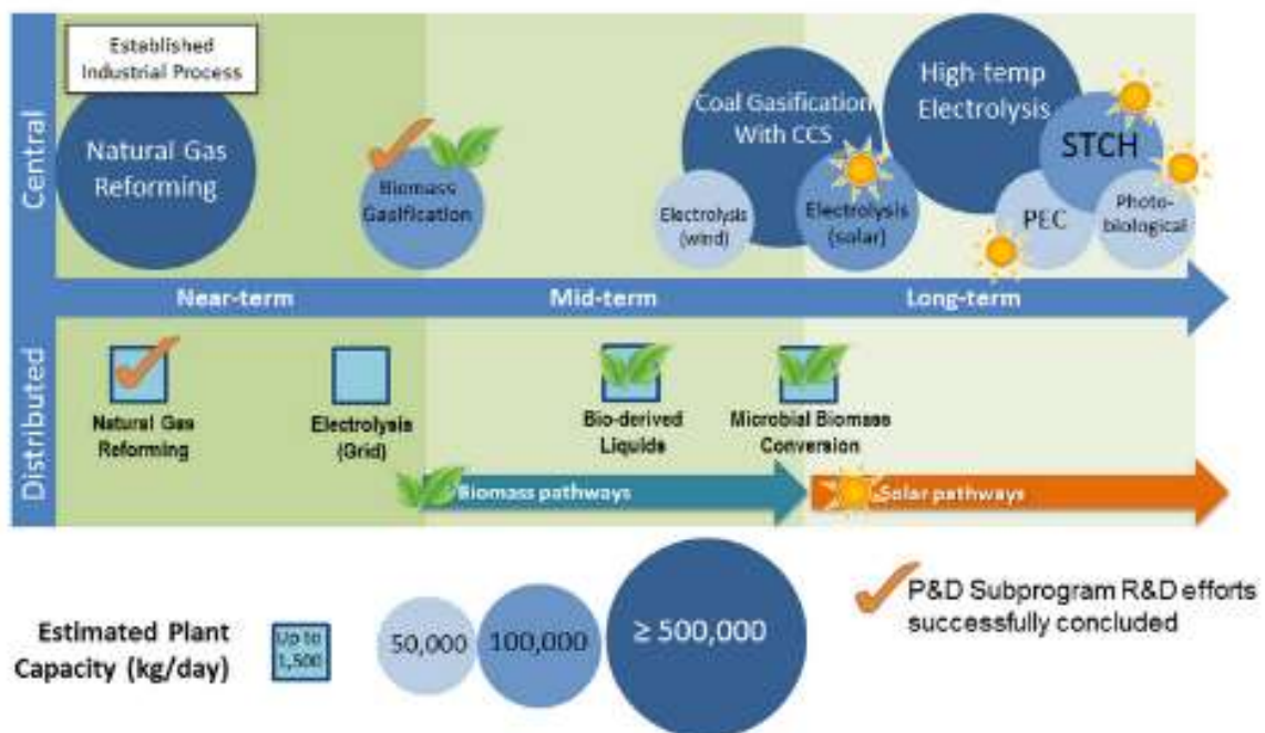
Figure 39 – Roadmap technologique des moyens de production propres d'hydrogène. Les premières technologies rentables visées seront la biomasse et l'éolienne puis à plus long terme le solaire.
